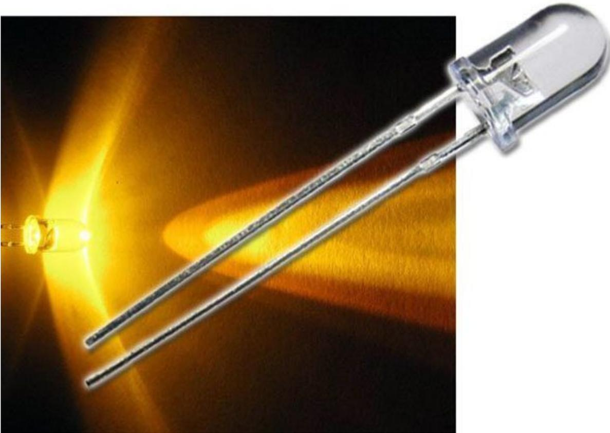
LED lampeggiante giallo. Lunghezza d'onda 590 nm, colore involucro: trasparente, diametro: 5 mm, alimentazione: 3-3,4 volt, corrente: 20 mA, frequenza lampeggio: circa 1 Hz (60 lampeggi al minuto)
