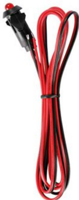
LED lampeggiante rosso completo di portaled e con 1 metro di cavo. Alimentazione 12 Vdc, portaled in ABS nero, fissaggio a vite. Dimensioni (mm): Ø 8x18.
