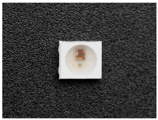
LED Neopixel a montaggio superficiale incredibilmente piccolo (2,4 mm x 2,7 mm x 1,1 mm), metà delle dimensioni di un Neopixel 3535 e un quarto di un 5050. Internamente dispone del chip WS2812B che permette di collegare molti di questi LED in cascata, utilizzando solo 1 pin di controllo. Può essere controllato anche con Arduino e altro microcontrollore. Possono essere realizzate strip, matrici, ecc, l'unico limite è la fantasia. Dimensioni (mm): 2,7x2,4x1,1. La confezione comprende solo 1 LED.
