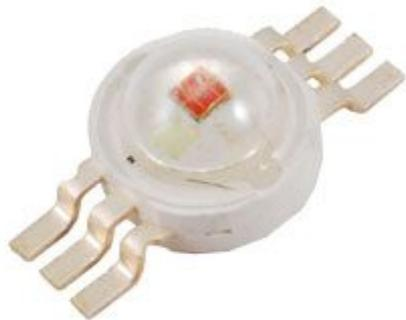
LED RGB a 6 piedini con 3 watt di potenza. Flusso luminoso (lumen): 70-80 (rosso), 130-150 (verde), 30-40 (blu); lunghezza d'onda (nm): 620-625 (rosso), 515-525 (verde), 460-470 (blu); angolo del fascio: 140°; alimentazione: da 2 a 2,4 Vdc (rosso), da 3,2 a 3,6 Vdc (verde), da 3,2 a 3,6 Vdc (blu); temperatura di funzionamento: da -25°C a +120°C; temperatura di stoccaggio: da -40°C a +80°C; temperatura per la saldatura: 330°C massimo 5 secondi; vita media: 50.000 ore.
