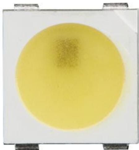
LED a tecnologia NEOPIXEL, dotato di 4 pin. Internamente dispone del chip WS2812B che permette di collegare molti di questi LED in cascata, utilizzando solo 1 pin di controllo. Può essere controllato anche con Arduino e altro microcontrollore. Possono essere realizzate strip, matrici, ecc, l'unico limite è la fantasia. Dimensioni (mm): 5x5x1,45.
