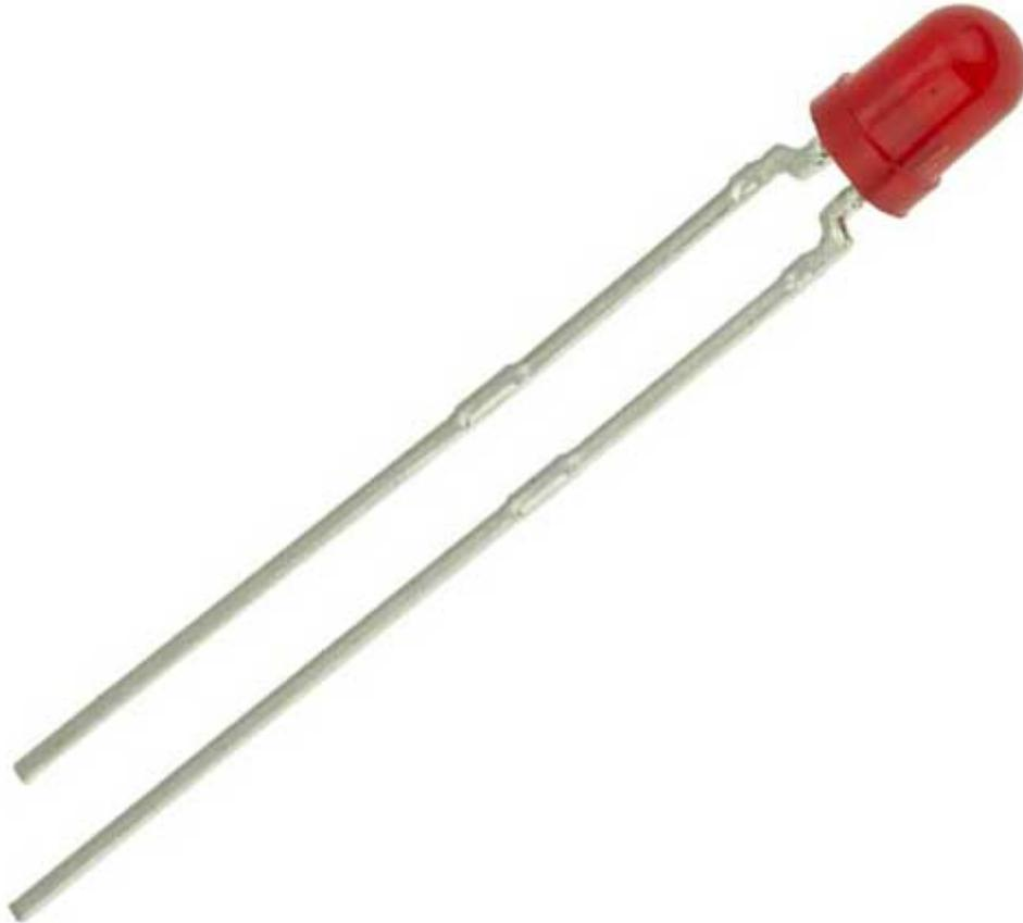
LED rosso 3 mm (T-1), lunghezza d'onda 625 nm, angolo di emissione 60°, intensità luminosa 10 mcd, dimensioni 3 x 8.7 mm, tensione diretta 3 V.
