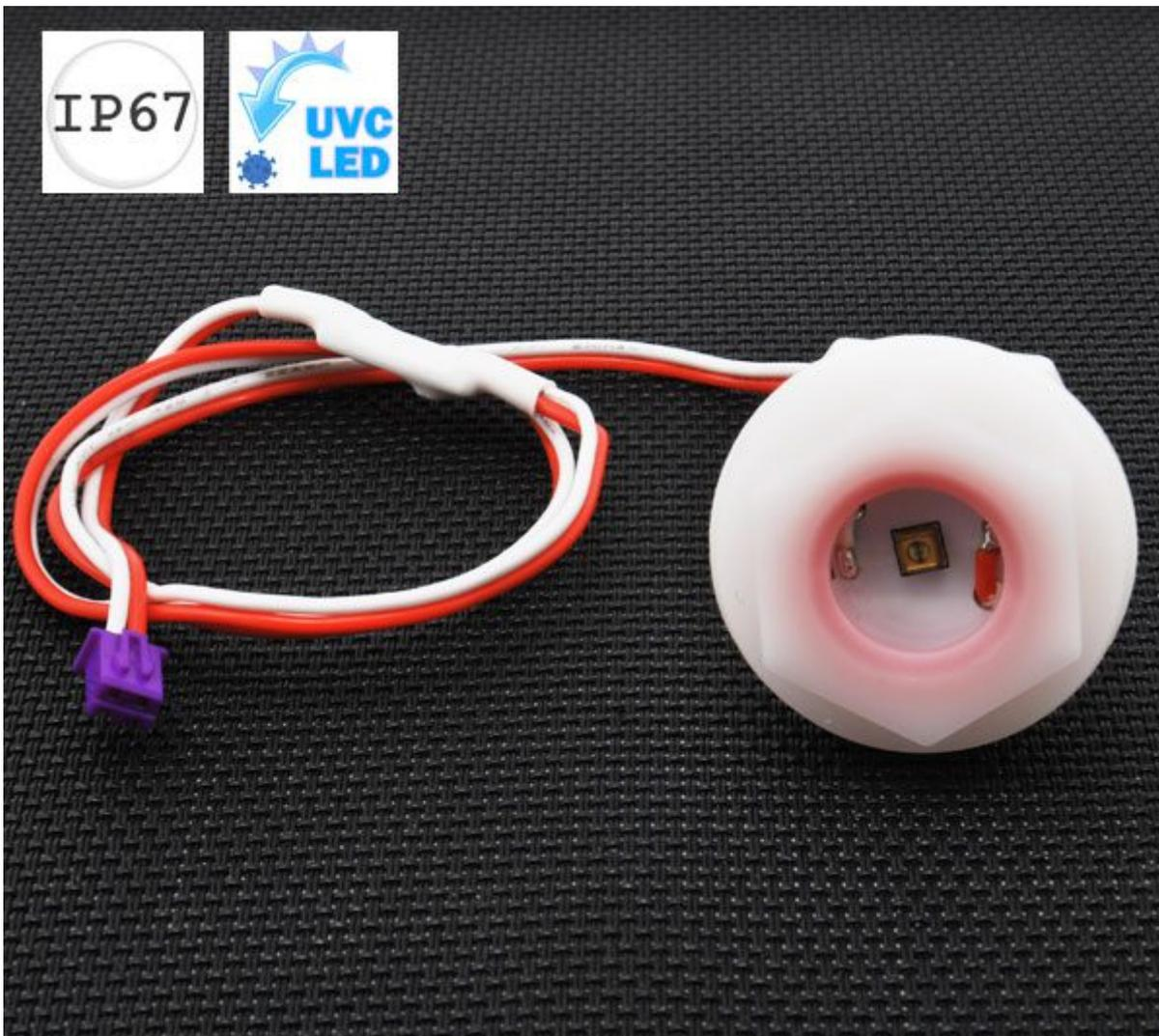
Inserito in un alloggiamento con grado di protezione IP67 e dotato di lente piatta, questo LED UVC è particolarmente indicato per acquari, per realizzare dispositivi per la sterilizzazione e la sanificazione di superfici e oggetti. La sanificazione viene attuata sfruttando la luce ultravioletta UVC emessa dal LED. La lunghezza d'onda emessa è compresa nella banda dei 270 nm e i 280 nm, garantendo la totale efficacia germicida e sterilizzante. Alimentazione a 12 volt.
