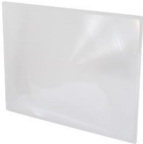
La lente di [Fresnel](#) permette la costruzione di ottiche di grande dimensione e piccola distanza focale con notevole riduzione degli ingombri rispetto ad una lente tradizionale. Per ogni zona lo spessore della lente viene limitato, trasformando la curva in una serie di superfici con la stessa curvatura, ma non continue. Applicazioni: condensatore per illuminatori flash, lente d'ingrandimento, sfruttamento energia solare, motore stirling, forno solare, lente ustoria.
