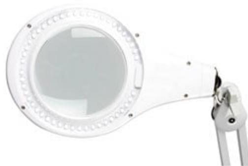
Lente d'ingrandimento a 5 diottrie (ingrandimento 2,25 x) con lampada costituita da 48 LED bianchi (1600 mcd/LED). Particolarmente indicata per lavori di precisione, dispone di interruttore on/off, braccio regolabile 86 cm con snodo all'estremità superiore. Alimentazione 230 Vac con un consumo di soli 4 watt. Colore bianco. Fissaggio da banco tramite morsetto.
