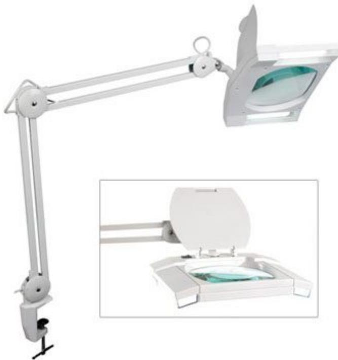
Lente d'ingrandimento a 3 diottrie (1,75 x) con illuminatore al neon particolarmente indicata per eseguire lavori di precisione. Dispone di due lampade fluorescenti laterali da 9 W e di un doppio braccio bilanciato, lungo 86 cm, che ne permette l'orientamento nella posizione più adatta. Fornita di morsetto metallico per il fissaggio al banco. Alimentazione 230 Vac. Colore bianco.
