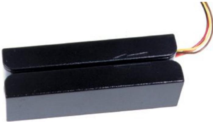
Il dispositivo contiene una testina magnetica e un apposito circuito di amplificazione in grado di leggere i dati presenti sulla traccia ISO2 del badge e di convertirli in impulsi digitali. Standard di lettura ISO 7811; traccia di lavoro ISO2 (ABA); metodo di lettura F2F (FM); alimentazione a 5 volt DC; assorbimento massimo 10 mA; velocità di lettura da 10 a 120 cm/sec.
