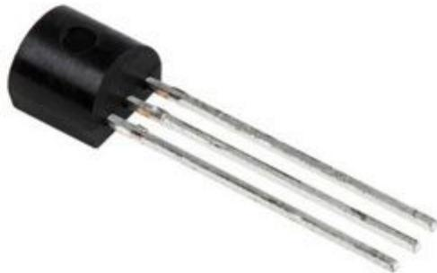
Sensore di temperatura analogico con uscita lineare. Opera come un diodo zener a due terminali con una tensione di rottura direttamente proporzionale alla temperatura assoluta a  $10 \text{ mV}/^\circ\text{K}$ . Adatto per essere utilizzato in vari dispositivi come elettrodomestici, telefoni cellulari, giochi, unità disco, gestione della batteria, strumenti medici portatili e stampanti.
