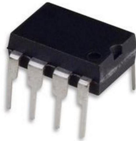
Amplificatore di Potenza Audio, 1W – Da 4V a 12V, DIP 8.
