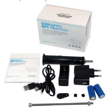
Originale e compatto localizzatore GPS e GSM/GPRS per bicicletta. Si inserisce nel tubo dello sterzo o nel sottosellino (il tubolare deve avere un diametro di almeno 23,5 mm e una profondità superiore ai 110 mm) e rimane così completamente occultato. Può inviare le proprie coordinate (latitudine e longitudine) via SMS verso telefoni cellulari, oppure, tramite tecnologia GPRS, ad un computer opportunamente configurato.
