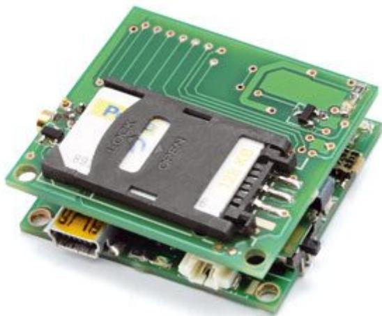
Permette di stabilire la posizione di un automezzo, una persona o un oggetto che montano o tengono in tasca questo dispositivo, sfruttando le coordinate delle celle agganciate della rete telefonica GSM. Il localizzatore funziona a batteria e quindi può essere utilizzato da persone che possono avere l'esigenza di chiedere aiuto o di venire rintracciate, ma anche sistemato a bordo di autoveicoli (senza necessità di installazione) o semplicemente introdotto in merci viaggianti.
