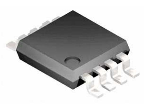
L'integrato LTC3642 della Linear Technology è un convertitore DC/DC step down ad alta efficienza. Tensione d'ingresso: da 4,5 V a 45 V, tensione di uscita: massima 5,015 V, corrente di uscita: massima 50 mA., package: MSOP, montaggio: SMT, dimensioni (mm): 3x3x0,86, numero di pin: 8, temperatura di funzionamento: da -40°C a +125°C.
