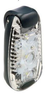
Luce multifunzione dotata di 3 LED a luce bianca ultra luminosi. Può funzionare in modalità lampeggiante o a luce fissa, dispone di clip di fissaggio per cintura o zainetto. Grazie all'ampio angolo di visibilità, consente di essere visibili anche da lontano. Alimentazione: 2 batterie CR2032 (comprese), autonomia: in modalità lampeggiante: circa144 ore, in modalità a luce fissa: circa 72 ore, dimensioni (mm): 55x28x18, peso: 20 grammi.
