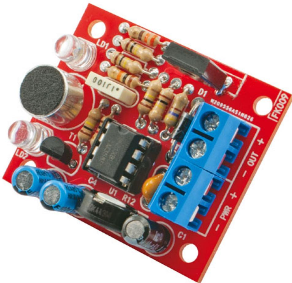
Luce psichedelica a LED con ingresso microfonico, sensibilità regolabile e possibilità di pilotare lampade di potenza a 12V microfonica. Dispone inoltre di un Darlington che pilota un'uscita di potenza, grazie alla quale è possibile pilotare un faretto quale pilotare una lampadina a 220 VAC a incandescenza, in funzione di faretto: un esempio di tale componente potrebbe deboli di udito, giacché può essere utilizzato per rivelare il suono del telefono e del campanello e segnalarlo col lampeggi
