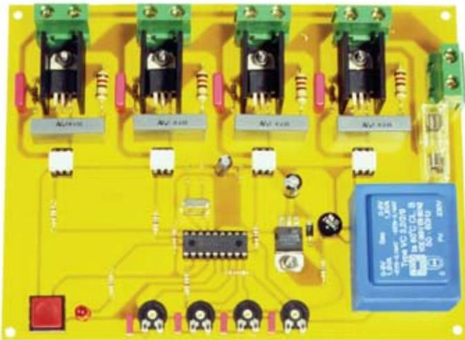
Per rendere ancora più realistico il vostro presepe, piccolo o grande che sia: un impianto luci in grado di simulare ciclicamente l'avvicinarsi del giorno e della notte. Il nostro circuito è in grado di pilotare quattro carichi luminosi resistivi corrispondenti alla luce del giorno, al bagliore delle stelle, al fuoco delle case ed alla stella cometa. Potenza di uscita massima di 2.000 watt per canale. Tutte le funzioni vengono gestite da un microcontrollore.
