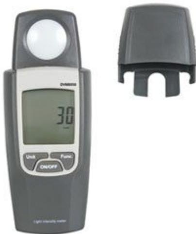
Strumento per la misura dell'illuminamento ambientale con indicazione digitale da 0 a 90.000 lux (da 0 a 8300 ftc) tramite display LCD a 6 cifre. Unità di misura lux ( $\text{lm}/\text{m}^2$ ), foot-candele ( $\text{lm}/\text{ft}^2$ ). Alimentazione 3 batterie 1,5 V AAA (incluse).
