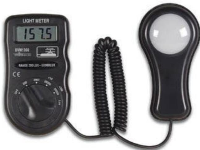
Strumento per la misura dell'illuminazione con indicazione digitale da 0.01lux a 50000lux tramite display a 3 1/2 cifre. Funzionamento a batterie, indicazione di batteria scarica, indicazione di fuoriscala. Sonda con cavo della lunghezza di circa 1 metro. Completo di custodia.
