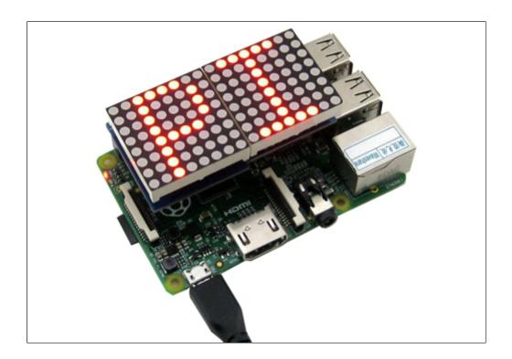
Modulo con 2 mini display a matrice, ognuno formato da 64 LED rossi da 3 mm a catodo comune e gestiti dall'integrato MAX7219. Si inserisce direttamente sul connettore di Raspberry Pi e possono essere visualizzate lettere, cifre e simboli. Alimentazione: tramite Raspberry, dimensioni (mm): 64,3x35x26,5, peso: 27 grammi.
