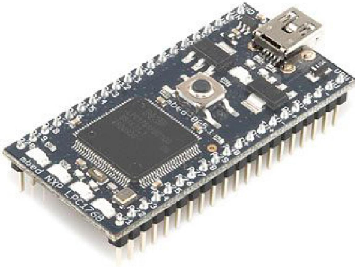
MBED è una scheda basata sul microcontrollore a 32-bit ARM® Cortex™ NXP LPC1768 funzionante a 96 MHz. Progettata specificamente per la prototipazione a basso costo di dispositivi Ethernet, USB e applicazioni alimentate a batteria. Dispone di una memoria flash da 512 kB, RAM 32 kB, interfaccia Ethernet, USB, CAN, SPI, I<sup>2</sup>C, ADC, DAC, PWM e altre interfacce di I/O. Il compilatore IDE è online, quindi funziona su Mac, Windows e Linux, e consente di scrivere
