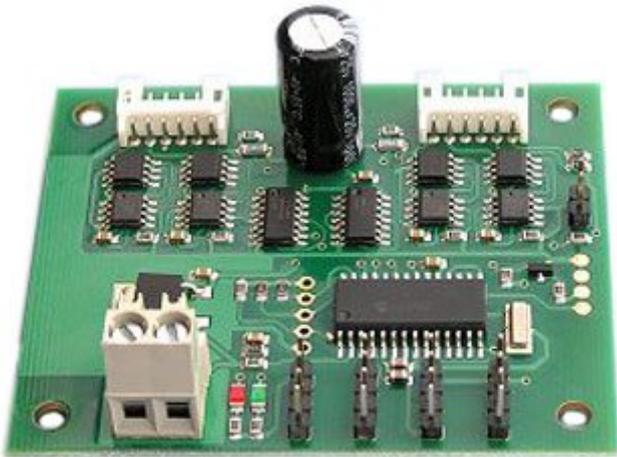
Il modulo MD23 è un robusto driver con controllo I2C per due motori, può essere interfacciato ad una vasta gamma di microcontrollori come: PICAXE, OOPic, BS2p, PIC, AVR, 8051's ecc. Particolarmente indicato per essere utilizzato con i motoriduttori EMG30. Dimensioni: 72 x 60 mm.
