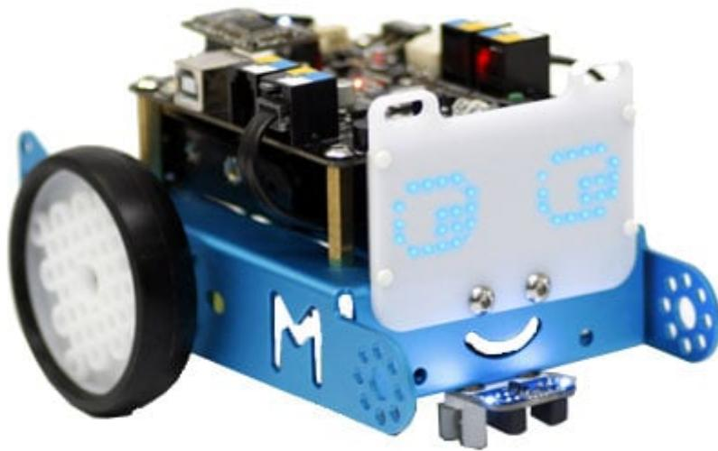
Costituito da una piastra frontale in plexiglass bianco, un pannellino con una matrice di 8x16 LED SMD blu, questo set permette di aggiungere al vostro "mBot" varie animazioni, testi, espressione del viso (occhi, bocca, ecc). Si programma graficamente tramite "mBlock". La confezione comprende: 1 pannellino in plexiglass bianco, una matrice 8x16 LED blu, rivetti plastici, cavetto con connettore RJ45. Alimentazione: 5 Vdc, dimensioni (mm): 73x32x20. **N.B.** il robot mBot non è compreso.
