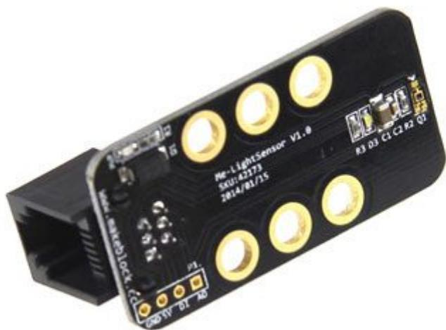
Dotato di un LED bianco e una fotoresistenza, Me Light Sensor è un modulo della serie Makeblock Me, progettati per essere semplici da programmare e facili da collegare. Me light può essere utilizzato con Arduino o con la Me BaseBoard V1.0, per accendere o spegnere un dispositivo in base alla luce ambiente, misurare i livelli di grigi, ecc. Dispone di connettore a 6 pin RJ25 e libreria Arduino per una facile programmazione.
