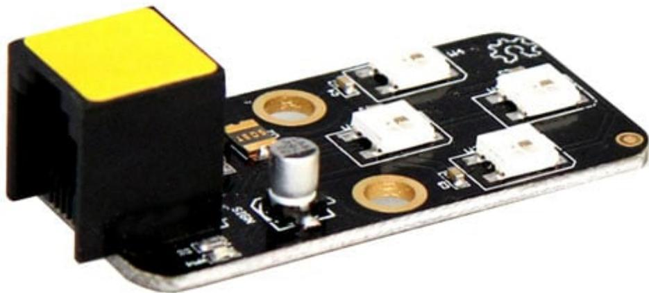
Dotato di 4 LED RGB con chip WS2812, Me RGB LED V1.0 è un modulo della serie Makeblock Me, progettati per essere semplici da programmare e facili da collegare. È possibile controllare ogni LED singolarmente per regolare la luminosità e creare qualsiasi colore miscelando il rosso, il verde e il blu. Particolarmente indicato per essere utilizzato con la ME Base Board V1, dispone di fusibile autoripristinante, connettore a 6 pin RJ25 e libreria Arduino per una facile programmazione.
