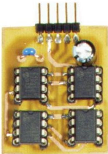
Banco di memoria da utilizzare in abbinamento alla demoboard per sistemi GPS (FT441K). Il kit comprende le quattro memorie con i relativi zoccoli, condensatori, strip e basetta doppia faccia, serigrafata e con fori metallizzati.
