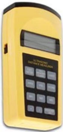
Metro ad ultrasuoni con puntatore laser con display LCD con cifre da 12 mm. Permette di misurare in modo estremamente facile e veloce, distanze comprese tra 95 cm e 18,25 m, in stanze, edifici in costruzione, ecc. Funzione per il calcolo istantaneo di aree e volumi, ideale per professionisti, utilizzatori artigiani e per chi ha bisogno di uno strumento di misurazione di buona affidabilità. Alimentazione a batteria da 9 V.
