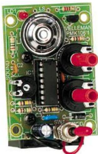
Fornito con altoparlante. LED indicatore di battito. Volume e numero di battiti per minuto regolabili tramite potenziometri. Interruttore sul circuito stampato.
