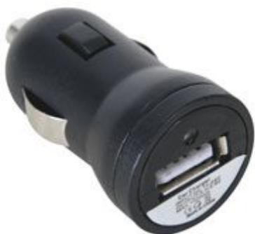
Micro adattatore da auto con presa USB per IPOD®, lettori MP3/MP4, PDA e GSM. Tensione d'ingresso 12-24 Vdc, tensione d'uscita 5 Vdc / 1 A. Protetto da sovraccarico e cortocircuito.
