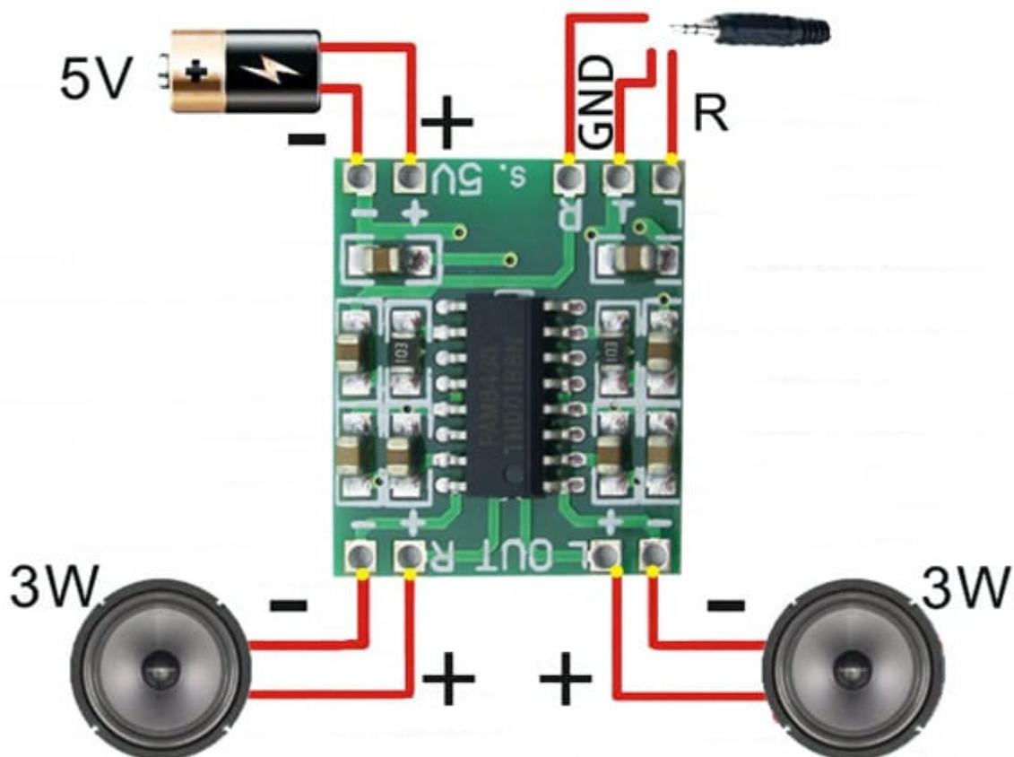
Basato sul chip PAM8403, questo piccolo amplificatore stereo in classe D è in grado di erogare una potenza massima 3 W su 4 Ohm (funziona anche con altoparlanti da 8 ohm). Alimentazione: da 2,5 Vdc a 5,5 Vdc, potenza di uscita: 2x3 watt (5V 4 ohm), dimensioni (mm): 21x18x3,2. Particolarmente indicato per essere utilizzato con piccoli lettori MP3.
