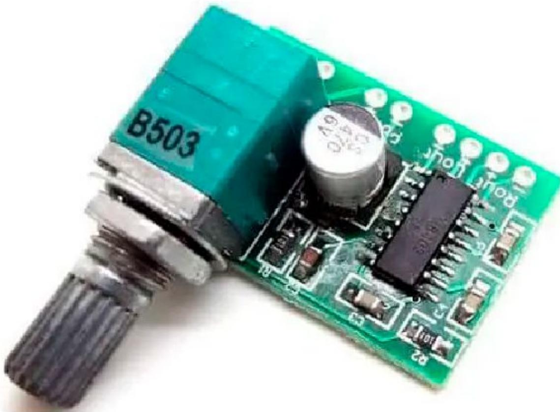
Basato sul chip PAM8403, questo piccolo amplificatore stereo in classe D è in grado di erogare una potenza massima 3 W su 4 Ohm. Dispone di potenziometro per la regolazione del volume e interruttore on/off. Alimentazione: da 2,5 Vdc a 5,5 Vdc, potenza di uscita: 2x3 watt (5V 4 ohm), dimensioni (mm): 33x19x16. Particolarmente indicato per essere utilizzato con piccoli lettori MP3. Attenzione! non alimentare con una tensione superiore a 5,5 V e non invertire la polarità.
