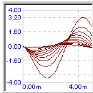
Analisi dei transienti. Simulazione del comportamento del circuito in relazione alla variazione di un parametro. Visualizzazione delle forme d'onda con un semplice click del mouse.
