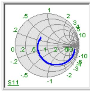
Rappresentazione tramite carta di Smith. Curve di impedenza, guadagno, trasmissione, riflessione su specifiche RF. Visualizzazione dei parametri S.
