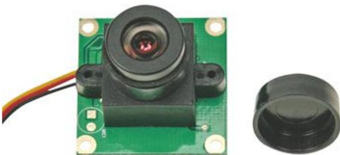
Telecamera miniatura (28 x 28 mm) dotata di sensore CMOS a colori da 1/3" con una risoluzione di 380 linee TV. Ottica da 3,8 mm, sensibilità 0,2 Lux e angolo di ripresa di 76,6°. Ideale per sorvegliare discretamente uffici, magazzini, ecc.
