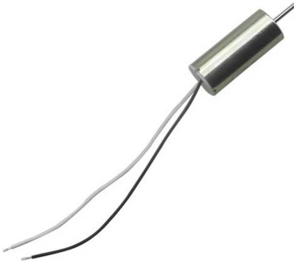
Micro motore con velocità di rotazione di 40.000 rpm, alimentazione 3,7 VDC e consumo di corrente di 110 mA (1,54 A in stallo). Motore: diametro 7 mm e lunghezza 16 mm, diametro albero motore 0,8 mm, lunghezza fili (nero e bianco) 70 mm, peso: circa 3 grammi.
