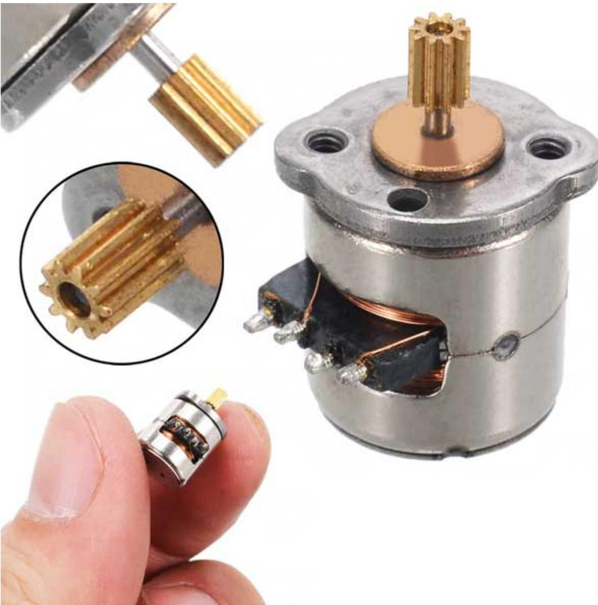
Motore passo-passo bipolare ultrapieno, Dimensioni (mm): 8 mm (diametro) x 9,2 (lunghezza), albero motore (mm): 0,8 (diametro) x 4 (lunghezza), alimentazione di 3 volt, peso: 2 grammi. Ideale per progetti dove sono richieste dimensioni estremamente ridotte come: robotica, automazione, ecc.
