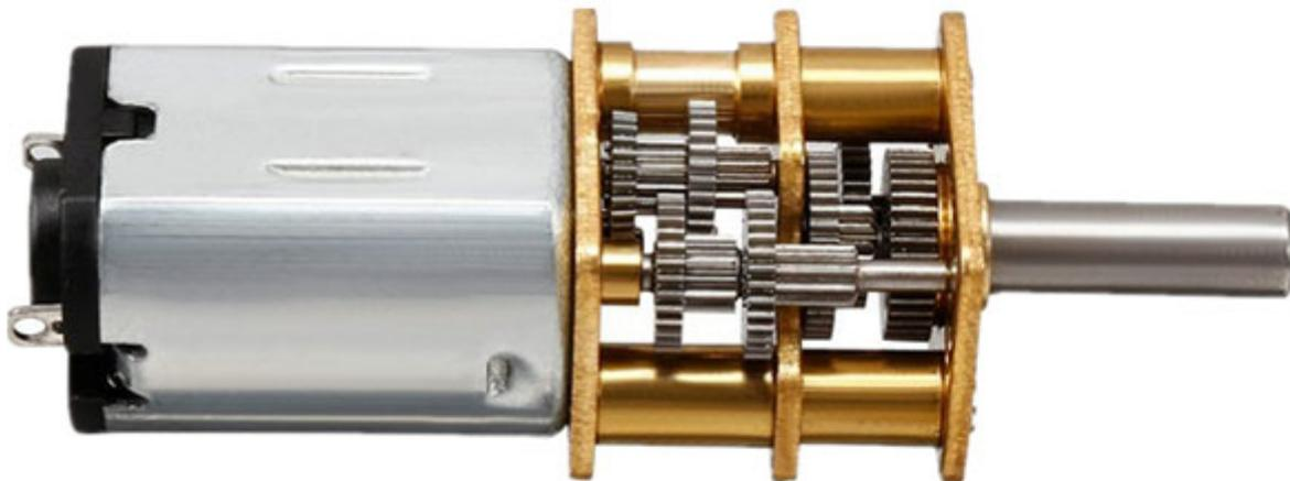
Micro motoriduttore in metallo funzionante a 12 Vdc con velocità 30 rpm e rapporto di riduzione 298:1. Alberino in metallo a forma di "D" lungo 9,27 mm, il frontalino in ottone ha due fori filettati per il montaggio di viti M1.6 (1,6 mm di diametro, passo del filetto 0,35 mm). Pesa circa 10 grammi. Direzione di rotazione secondo polarità. Particolarmente indicato per la realizzazione di Robot, automatismi, ecc.
