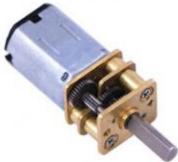
Micro motoriduttore in metallo funzionante a 6 Vdc con rapporto di riduzione 30:1. Alberino in metallo a forma di "D" lungo 9,27 mm, il frontalino in ottone ha due fori filettati per il montaggio di viti M1.6 (1,6 mm di diametro, passo del filetto 0,35 mm). Pesa circa 10 g. Direzione di rotazione secondo polarità. Particolarmente indicato per la realizzazione di Robot.
