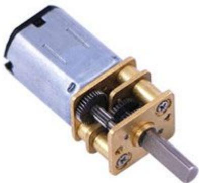
Micro motoriduttore in metallo funzionante a 6 Vdc con rapporto di riduzione 298:1. Alberino in metallo a forma di "D" lungo 9,27 mm, il frontalino in ottone ha due fori filettati per il montaggio di viti M1.6 (1,6 mm di diametro, passo del filetto 0,35 mm). Pesa circa 10 g. Direzione di rotazione secondo polarità. Particolarmente indicato per la realizzazione di Robot.
