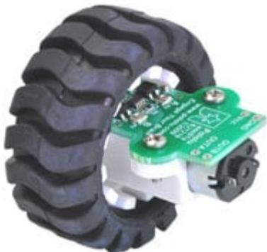
Encoder per ruota Pololu 42 x 19 millimetri
