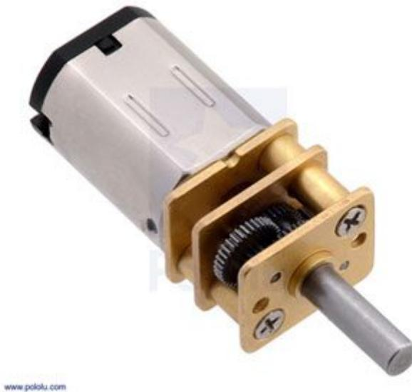
Micro motoriduttore in metallo, funzionante a 6 Vdc, ha un rapporto di riduzione 248,98:1 e una velocità senza carico di 50 rpm. Alberino in metallo a forma di "D" lungo 9 mm, il frontalino in ottone ha due fori filettati per il montaggio di viti M1.6 (1,6 mm di diametro, passo del filetto 0,35 mm). Pesa circa 10 g. Direzione di rotazione secondo polarità. Particolarmente indicato per la realizzazione di Robot.
