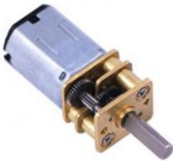
Micro motoriduttore in metallo funzionante a 6 Vdc con rapporto di riduzione 150:1. Alberino in metallo a forma di "D" lungo 9,27 mm, il frontalino in ottone ha due fori filettati per il montaggio di viti M1.6 (1,6 mm di diametro, passo del filetto 0,35 mm). Pesa circa 10 g. Direzione di rotazione secondo polarità. Particolarmente indicato per la realizzazione di Robot.
