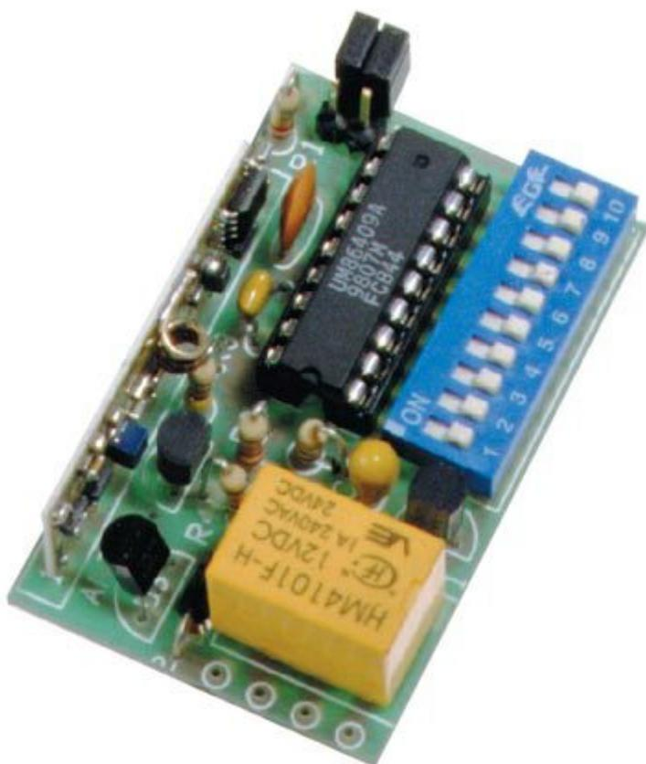
Ricevitore miniaturizzato monocanale ad impulso, completo di antenna e racchiuso in un contenitore plastico di ridotte dimensioni (il circuito misura 32 x 52 x 17 mm); utilizza un modulo Aurel BC-NBK a 433 MHz omologato CE ed un comune integrato di codifica a 4096 combinazioni. Fornito con il contenitore.
