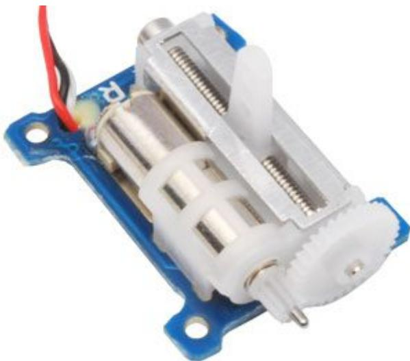
Servo analogico ultra piccolo. Corsa: circa 11 mm, forza di torsione: 0,2 kg•cm, peso: 1,8 grammi, alimentazione: da 3,7 Vdc a 5 Vdc, consumo a 5V: 400 mA, velocità: 0,12 secondi/60°, dimensioni (mm): 18,50 (lunghezza) x 15 (larghezza) x 6,5 (altezza). Materiale ingranaggi: Nylon. Ideale per essere impiegato in piccolissimi aerei ultraleggeri o in particolari applicazioni dove servono, dimensioni ridotte e peso molto contenuto.
