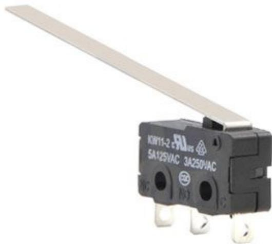
Micro switch con levetta in metallo lunga 50 mm. Dispone di un contatto normalmente aperto e di uno normalmente chiuso. I terminali sono a saldare. Fissaggio mediante viti o collante. Particolarmente indicato come rilevatore di ostacoli per robot. Dimensioni del corpo sono 20x6,4x10,2 mm. Portata contatti: 5 A / 125 VAC - 3 A / 250 VAC.
