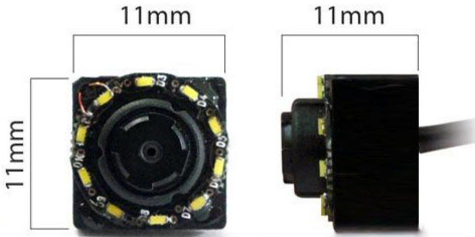
Micro telecamera a colori indicata per riprendere oggetti posti a breve distanza (da 8 a 100 mm). Dispone di elemento sensibile da 1/4" CCIQIII, 10 LED bianchi in SMD, una risoluzione di 560 linee TV, ottica da 3,4 mm/F6.0, illuminazione minima: 0.02 Lux/ F1.2 e alimentazione da 5 a 12 Volt. **Attenzione!** Non è indicata per videosorveglianza. Applicazioni: industriali, moduli endoscopici, ispezione tubature, ecc.
