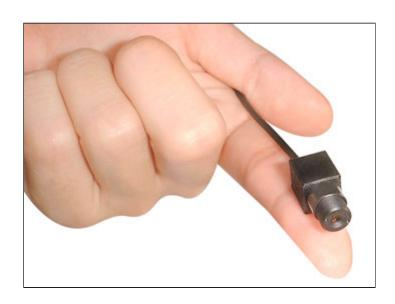
È tra le più piccole e compatte telecamere a colori esistenti in commercio. Realizzata in tecnologia CMOS, presenta una risoluzione di 240 linee TV e misura appena 9 x 9 x 20 millimetri. Ottica 3,7 mm / F=2.0, alimentazione da 9 a 12 Volt.
