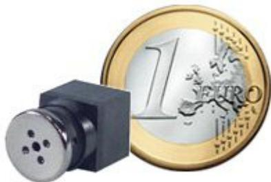
Micro telecamera a colori di piccolissime dimensioni facilmente occultabile dietro ad un vestito grazie al particolare obiettivo a forma di bottone. Realizzata in tecnologia CMOS, presenta una risoluzione di 380 linee TV e misura appena 12 x 12 millimetri. Ottica 3,6 mm / F=2.0, alimentazione 12 Volt.
