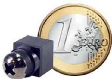
Micro telecamera a colori di piccolissime dimensioni facilmente occultabile dietro una parete grazie al particolare obiettivo a forma di vite. Realizzata in tecnologia CMOS, presenta una risoluzione di 380 linee TV e misura appena 12 mm di diametro. Ottica 4.3 mm / F 2.0, alimentazione da 5 a 12 Volt.
