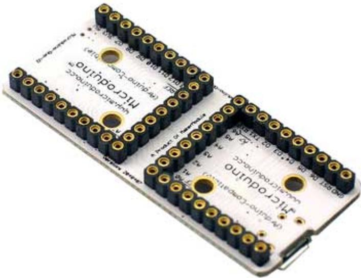
Questa piccola scheda di espansione, dotata di due connettori per Microduino interconnessi e disposti orizzontalmente, può essere impilata con qualsiasi modulo Microduino, formando diversi sistemi e riducendone l'altezza. Una parte della scheda dispone di connettore micro USB e Led di stato per alimentazione (5 V o 3,3 V), mentre l'altra parte dispone di pulsante di reset e connettore per interfaccia I2C.
